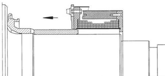
Fig.10 – Il riscaldatore viene posizionato sopra l'anello
