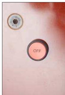
Fig.18 Bouton d'ARRÊT d'urgence à l'avant de la bobine
