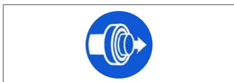
**Fig. 12 – Símbolo de modo de desmontaje**
