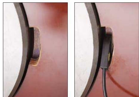
Bild 14 – Den Temperaturfühler in die Lücke an der Spule einsetzen.
