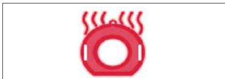
Fig.17 – Simbolo di avvertenza bobina troppo calda
