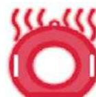
Fig. 17 – Símbolo de advertencia de bobina demasiado caliente
