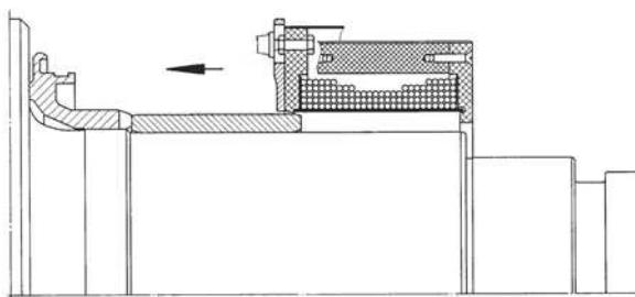
Рис. 10 Установка нагревателя на кольцо
