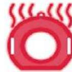
图 17 – 线圈温度过高警告符号
