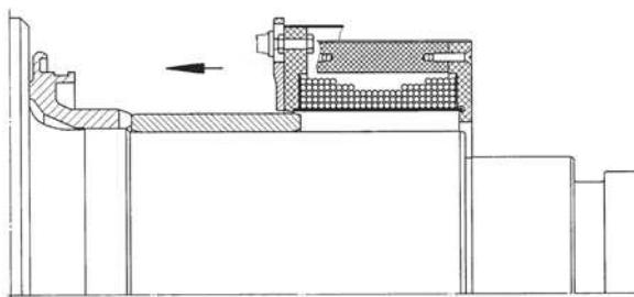
Fig. 10 – O aquecedor está sendo posicionado sobre o anel
