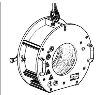
Fig.9 – N'utilisez pas une corde en acier pour soulever l'appareil de chauffage
