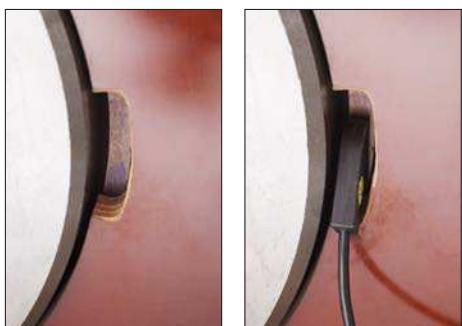
图 14 – 在线圈上的缺口处放置温度探头
