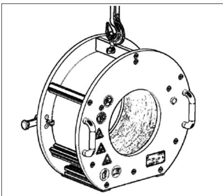
Рис. 9 Запрещается использовать стальные канаты для подъёма нагревателя
