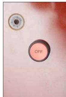
图 18 – 线圈前面的紧急停止按钮
