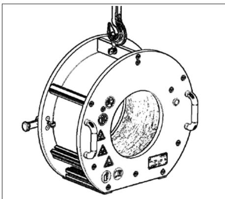
Fig. 9 – No utilice cuerdas de acero para elevar el calentador
