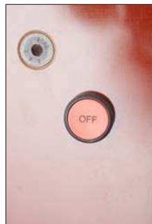
Bild 18 – Notaus-Taste an der Vorderseite der Spule
