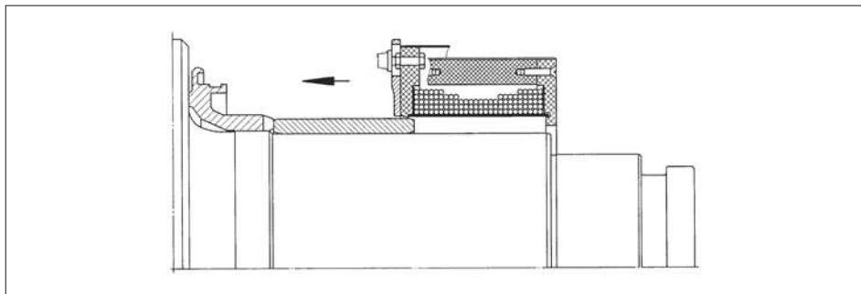
图 10 – 加热器被固定在套环上
