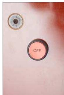
Fig. 18 – Botón de parada (STOP) de emergencia en el frente de la bobina
