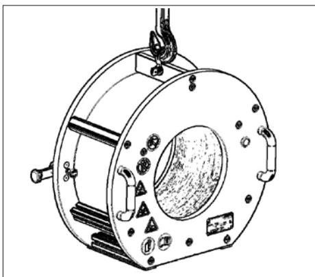
Bild 9 – Zum Anheben des Anwärmgeräts keine Stahlseile verwenden.
