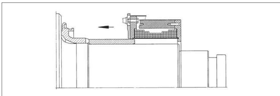
Bild 10 – Das Anwärmgerät wird über den Ring geschoben.
