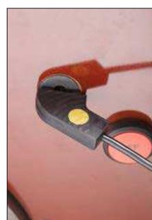
**Fig.15** – Placez la sonde magnétique sur une surface métallique, par exemple un boulon, sur l'EAZ
