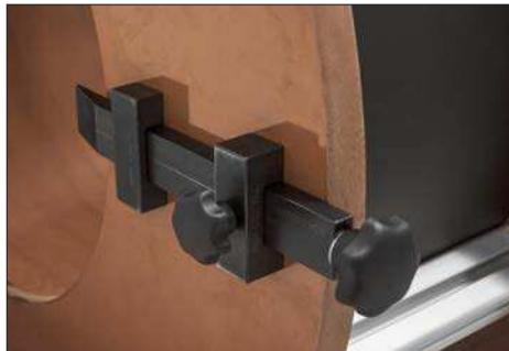
**Fig. 11 – Barra para retirar detrás de la bobina**
