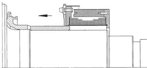
Fig. 10 – Posicionamiento del calentador sobre el aro
