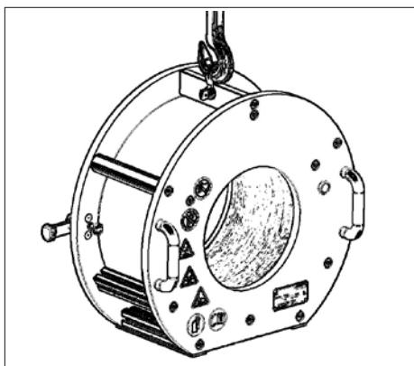
Fig.9 – Brug ikke stålreb til at løfte varmeren
