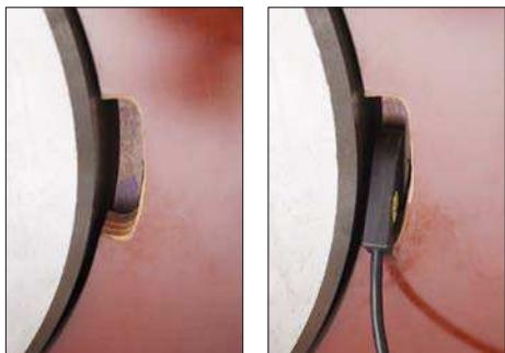
Рис. 14 Для установки термопары используйте выемку на катушке
